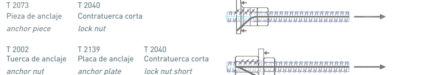
Anclaje final bajo carga de compresión
