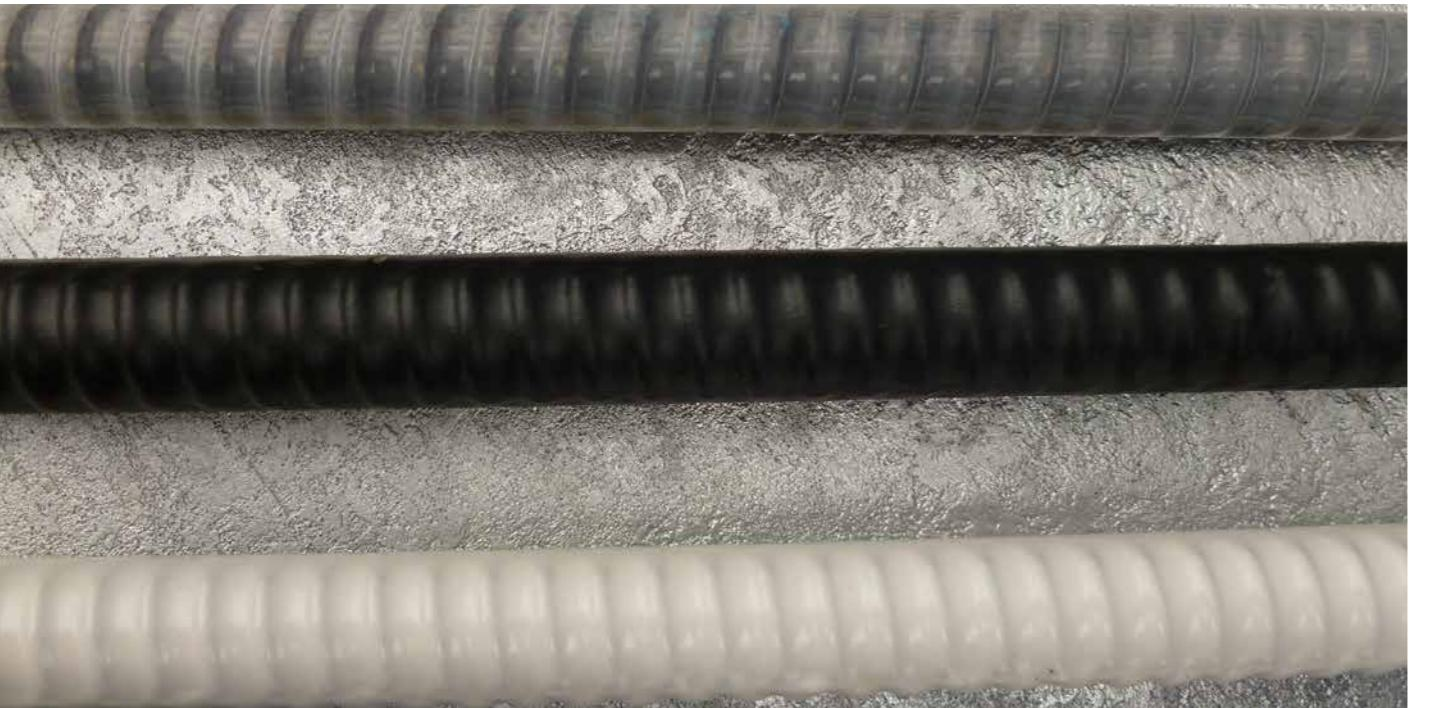
El proceso Dúplex es un sistema de protección contra la corrosión complementario, que consiste en un galvanizado combinado con uno o varios revestimientos posteriores vía húmeda o en seco. Se produce de esta forma un efecto de sinergia que puede incrementar entre 1,2 y 2,5 veces la vida útil de los distintos componentes, considerados éstos de forma individual. El sistema dúplex resulta eficaz debido a la protección que de forma mutua se ofrecen los dos componentes: galvanizado y revestimiento.
